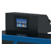
Dispositivo de alarma por falta de tinta
