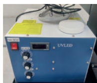
Sistema de curado UV LED refrigerado por agua de alta eficiencia
